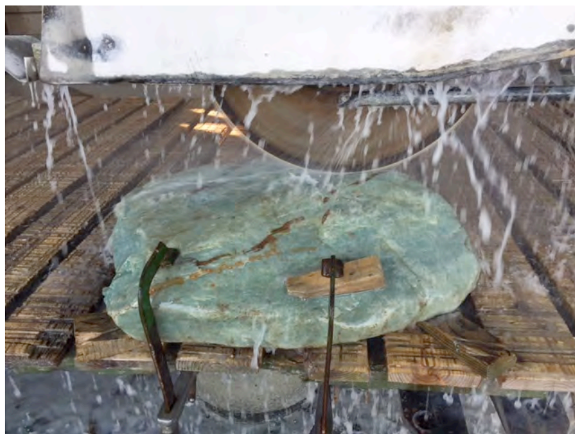
Fig. 2 Il taglio con mola diamantata
