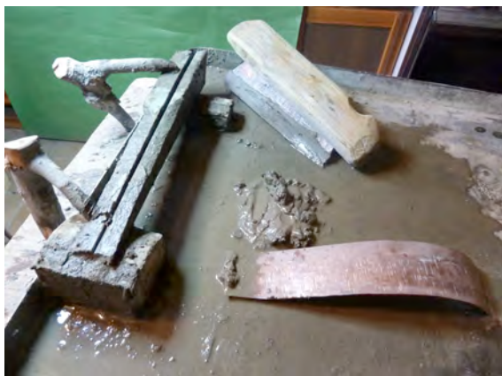
Figg. 18- 19 – Ritaglio in lavorazione e vista in sezione della superficie carenata ottenuta con lama in rame a sezione triangolare.
